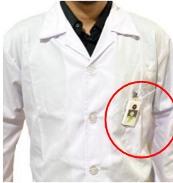
Pemasangan TLD Hp(10) pada saku baju pekerja
